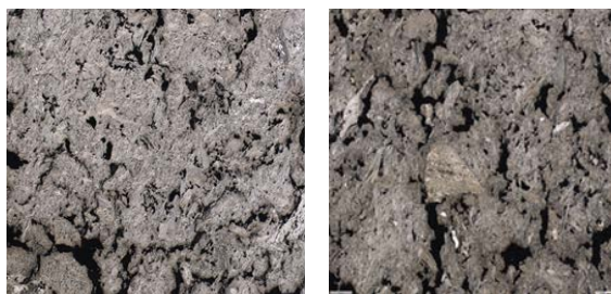
Рисунок 1 – Фотографии микроструктуры шлифа графитового материала поперечного (слева) и продольного (справа) разрезов
