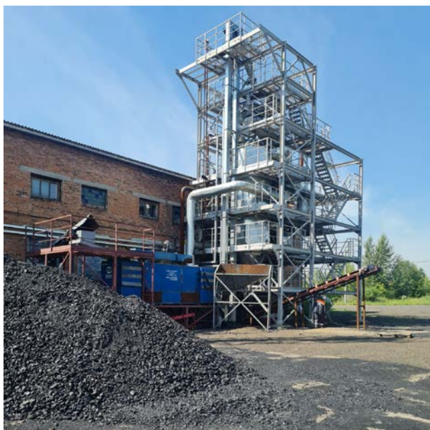
Рис. 1. Технологическая линия по производству углеродсодержащих брикетов производительностью 1,5 т/ч (г. Белово, Кемеровская область): слева – реактор карбонизации био-угольных гранул, справа – пресс-экструдер участка гранулирования
