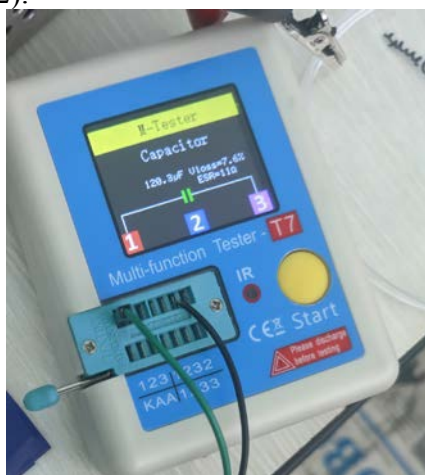
Рис.2. Показания LC-тестера T7 для образцы полярной углеродистой резины с нанесением электродов из УНТ
