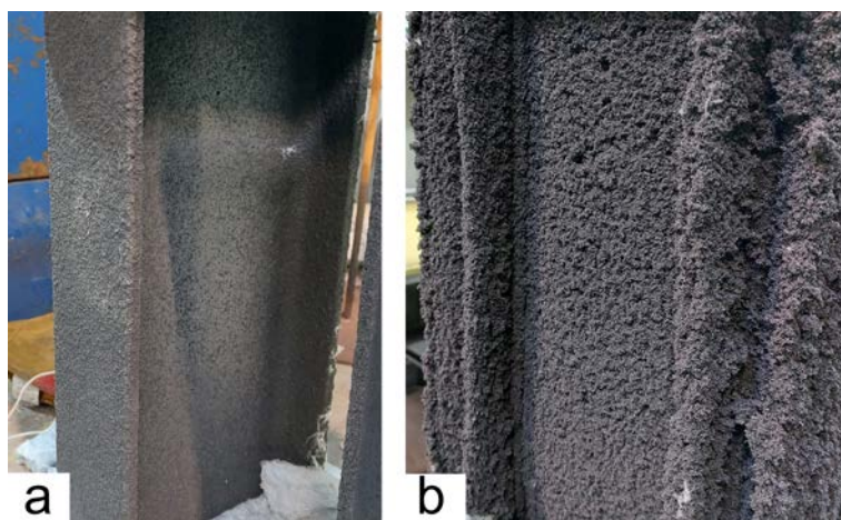
Рис. 1. Пенококс на основе ОГ: а) огнезащитное покрытие на поверхности защищаемой стальной колонны двутаврового сечения; б) структура пенокоса после огневых испытаний.
