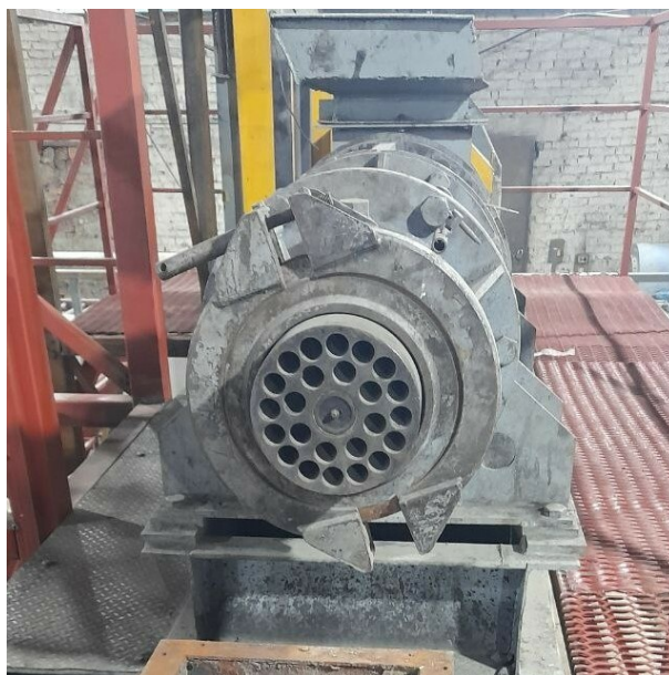
Рис. 1. Технологическая линия по производству углеродсодержащих брикетов производительностью 1,5 т/ч (г. Белово, Кемеровская область): слева – реактор карбонизации био-угольных гранул, справа – пресс-экструдер участка гранулирования
