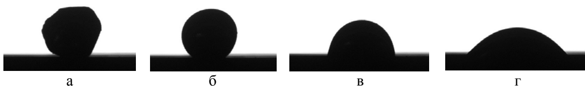
Рис. 1 – Форма капли при температуре 60 °С (а); 80 °С (б); 90 °С (в); 150 °С (г)
