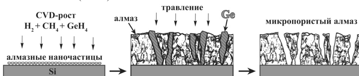
Рис. 1. Схема получения микропористых алмазных слоёв.
