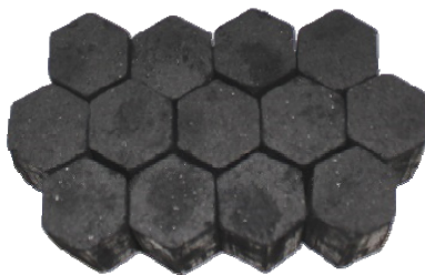
Рис. 1. Образцы формованного монолитного нанопористого активного угля АС-90S
