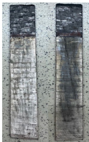
Рисунок 2. Гальваническое покрытие системы медь-никель на образце 2D-УУКМ
