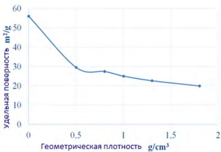
Рис. 1. (а) Зависимость внутренней удельной поверхности графитовой фольги от плотности;
